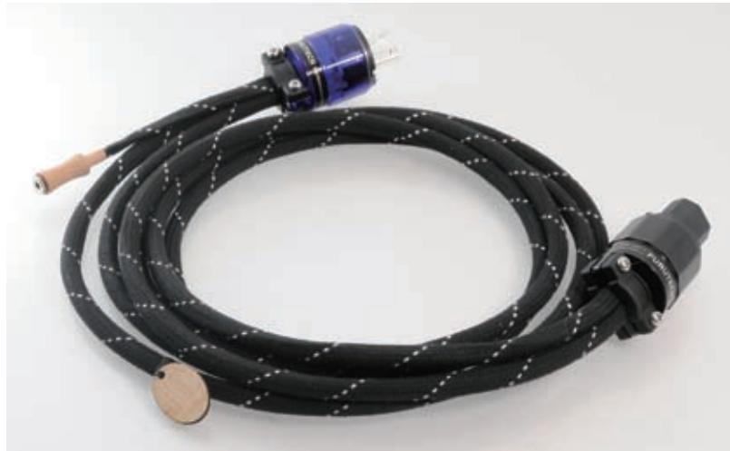
的電源線均引進了 EEDS 外部地端導洩系統，全部採用 Shot gun 接法，內部以非對稱設計結構 (Asymmetrical Construction) 將電磁干擾減到最低，Power Konstantin DDW 的中線及火線採用純銅導體，各自有獨立線身，減低訊號傳送時受磁場干擾，同時，線身穿上了天然棉外套，而且黑色染料也是天然的，以避免複合材質與顏色染料引來靜電干擾。Konstantin DDW 的頭尾插頭均是採用 Furutech 製品，頭是鍍銠而尾是鍍銀，型號
